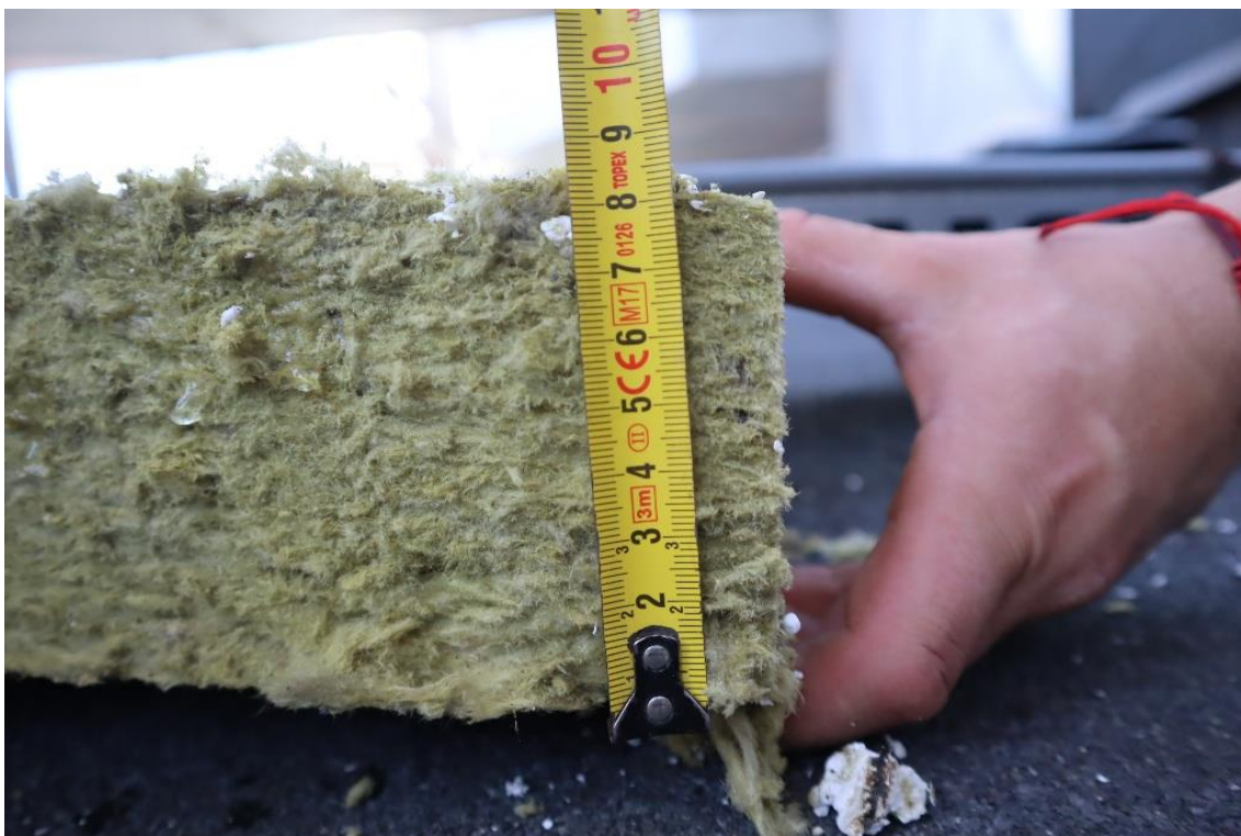
Fot. 63. Odkrywka nr 1 Włna mineralna gr. 8 cm
