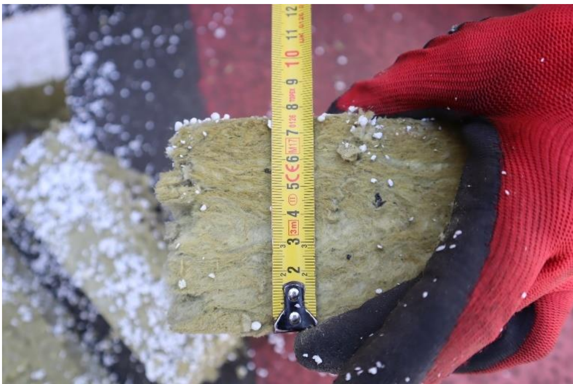
Fot. 74. Odkrywka nr 4 Wełna mineralna gr. 8 cm
